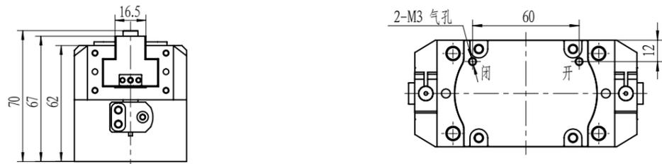
注：建议连接板沉孔 $\phi 5.5 \pm 0.4$ ，密封圈 $\phi 3.5 \times 1$ 。
