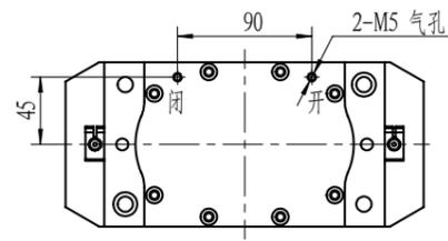
注：建议连接板沉孔φ8▽0.9，密封圈φ5\*1.5。
