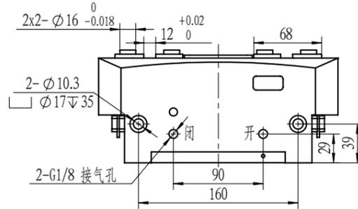
B底部通气款底部气孔尺寸示意
